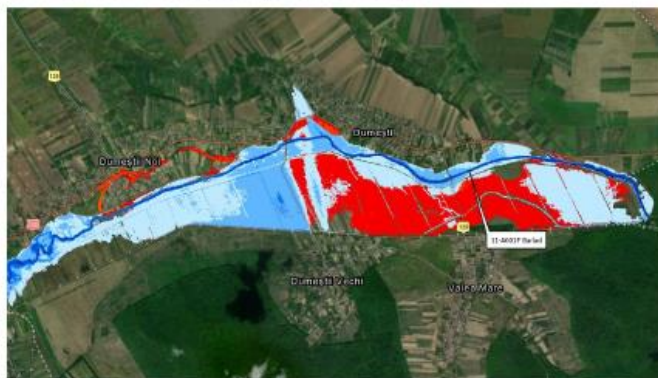
Figura 4-2 – Efectul măsurii din zona localității Dumești (îndepărtare dig mal drept și suprainălțare drum)
